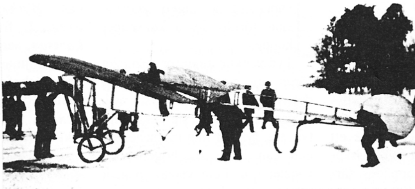
Dahlbecks Blériot-Nyrop på Värtans is. Flygplanet hade en Gnome-motor på 50 hkr och gjorde omkring 80 km/t
